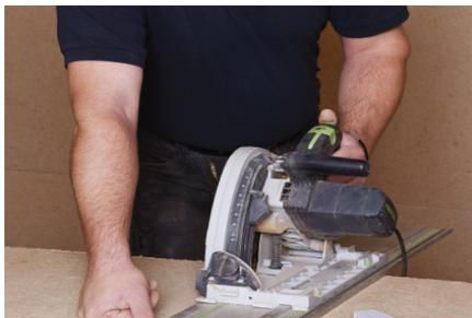
Die Lehmbauplatten sind mit einfachen Werkzeugen wie einer Stich- und Handkreissäge oder einem Fuchsschwanz zu schneiden (Staubmaske tragen).
