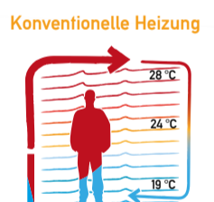
Konventionelle Heizkörper verursachen, durch unterschiedliche Temperaturschichten, Luftzirkulationen und Staubaufwirbelungen.
